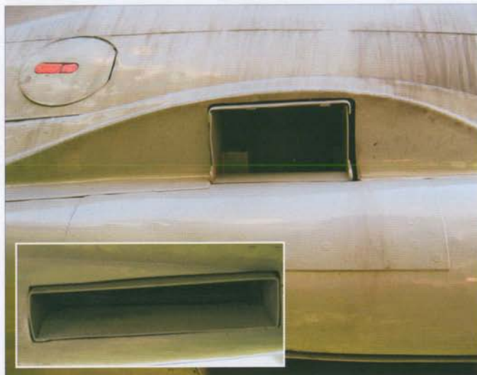
N-37D cannon's ammunition belt links and shell ejection port • Wyrzutnik ogniwi i łusek działka N-37D
