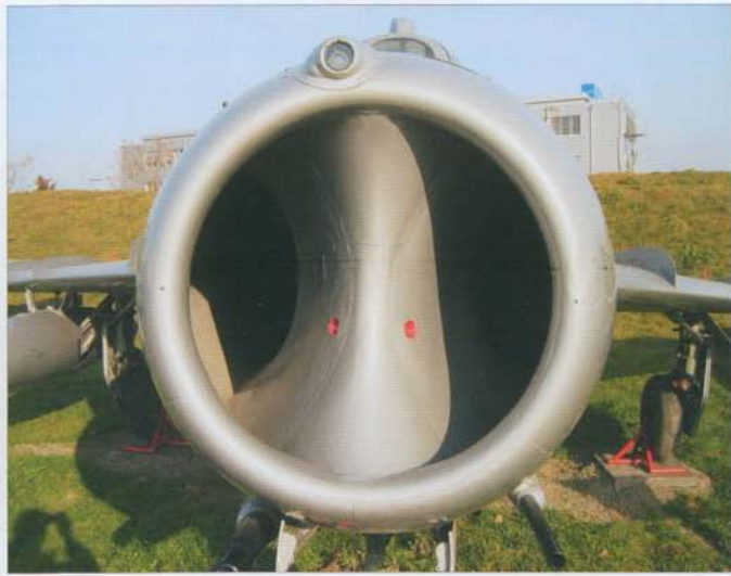
Nose engine air intake splits into two channels which pass either side of the cockpit • Chwyt powietrza z przegrodą dzielącą go na dwa kanały doprowadzające powietrze do silnika
