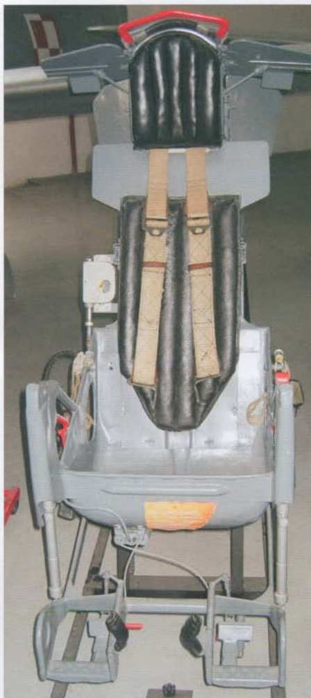
Ejector seat as used in MiG-17F/Lim-5. It allowed for safe extraction from the cockpit at a minimum altitude of 250 metres • Fotel wyrzucany stosowany w MiG-17F/Lim-5. Zapewniał awaryjne opuszczanie samolotu przy minimalnej wysokości 250 m
