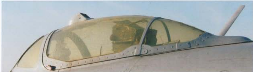
Cockpit comprised fixed front part and rearward-sliding hood. Note the blade antenna on the upper rear fuselage (starboard side, aft of the cockpit) • Osłona kabiny pilota. Część przednia była nieruchoma. Część tylna była odsuwana do tyłu. Po prawej tylnej stronie osłony kabiny znajdowała się antena mieczowa
