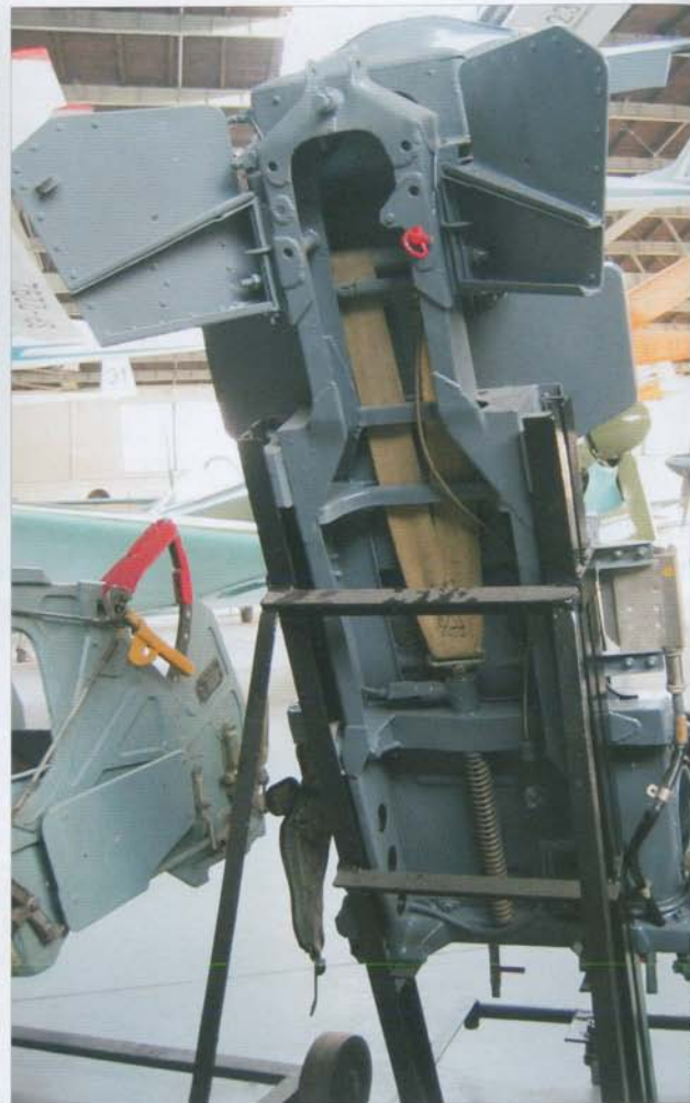
Ejector seat as used in MiG-17F/Lim-5. It allowed for safe extraction from the cockpit at a minimum altitude of 250 metres • Fotel wyrzucany stosowany w MiG-17F/Lim-5. Zapewniał awaryjne opuszczanie samolotu przy minimalnej wysokości 250 m
