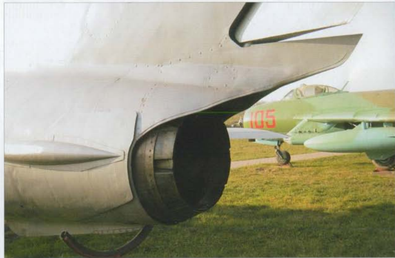
Engine nozzle • Dysza wylotowa silnika
