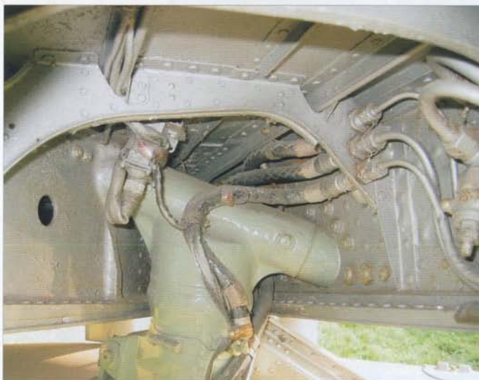
Port landing gear leg joint • Węzeł mocowania lewej goleni podwozia
