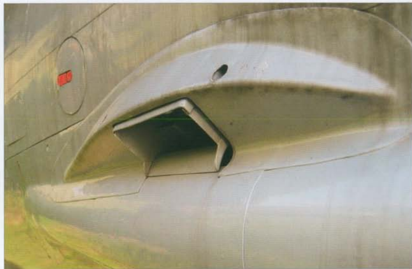
N-37D cannon's ammunition belt links and shell ejection port • Wyrzutnik ogniwi i łusek działka N-37D
