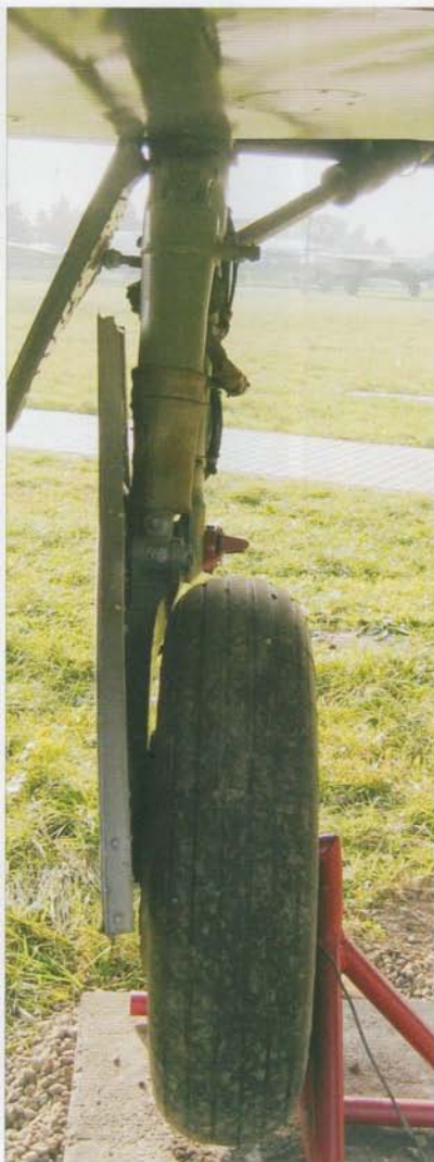
Port main landing gear leg; visible are brake lines and the light signalling the position of the undercarriage • Lewa goleń podwozia głównego z instalacją hamulcową oraz światłem wypuszczenia podwozia
