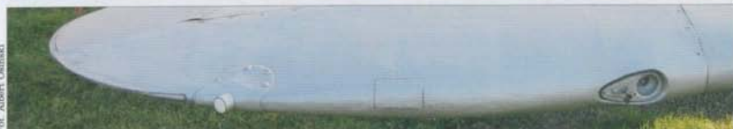
Starboard wing rigged with external fuel tank. Note the wingtip anti-vibration mass and position light • Prawy płatek z podwieszonym zbiornikiem paliwa. Na końcówce płata ciężar przeciwwibracyjny oraz światło pozycyjne
