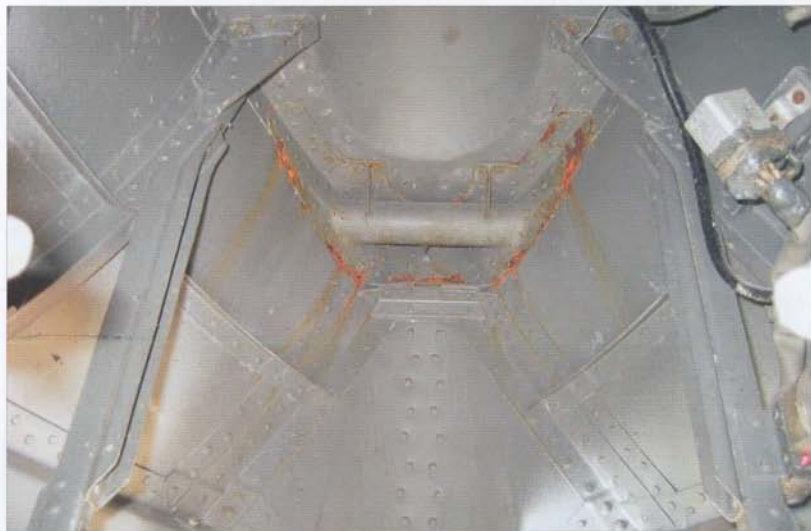
Front landing gear well. Its upper part features a bulge to house the wheel in its retracted position • Komora podwozia przedniego. Jej górna część zawiera przetłoczenie na chowane koło podwozia
