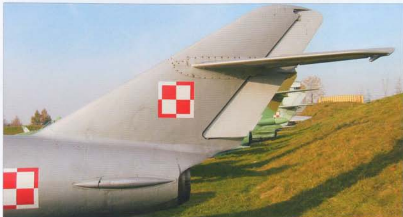
Tail assembly and engine. Starboard side of the tailfin is equipped with a flare launcher. Note the ventral fin with a ground bumper • Tylna część kadłuba z silnikiem oraz usterzeniem poziomym i pionowym. Po prawej stronie statecznika pionowego znajduje się rakietnica sygnałowa. Pod kadłubem grzebień zabezpieczający przed uszkodzeniami
