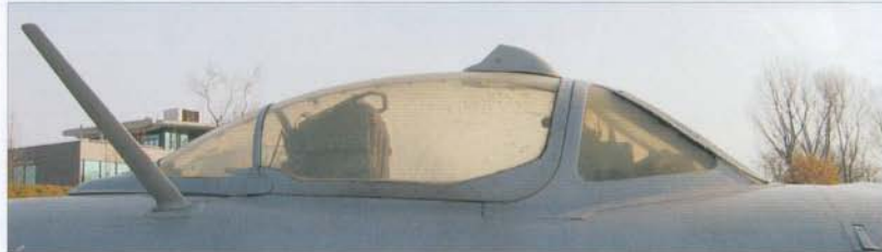
Cockpit comprised fixed front part and rearward-sliding hood. Note the blade antenna on the upper rear fuselage (starboard side, aft of the cockpit) • Osłona kabiny pilota. Część przednia była nieruchoma. Część tylna była odsuwana do tyłu. Po prawej tylnej stronie osłony kabiny znajdowała się antena mieczowa
