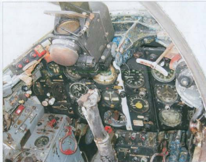
Control column and lower part of the cockpit • Dźwignia sterowniczy i dolna część kabiny pilota
