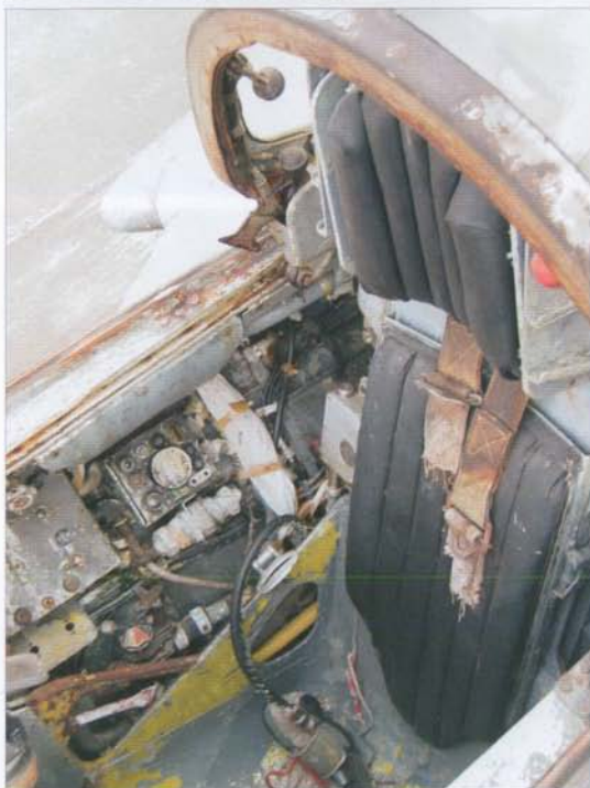
Ejector seat as used in MiG-17F/Lim-5. It allowed for safe extraction from the cockpit at a minimum altitude of 250 metres • Fotel wyrzucany stosowany w MiG-17F/Lim-5. Zapewniał awaryjne opuszczanie samolotu przy minimalnej wysokości 250 m
