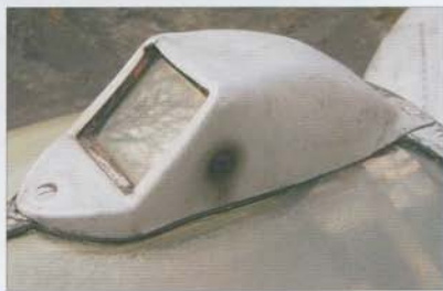
Armoured-glass windshield fitted with defroster installation • Wiatrochron ze szkła pancernego wyposażony w instalację przeciwoblodzeniową
