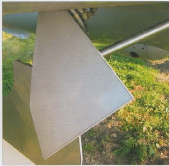
Details of the starboard main landing gear: shock-absorber, wheel, hydraulic installation and covers • Detale prawego podwozia głównego: amortyzator, koło, instalacja hydrauliczna i osłony
