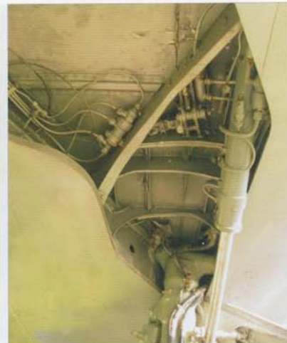
Port landing gear well and the leg actuator • Wnęka lewego podwozia z dźwignikiem wciągania podwozia
