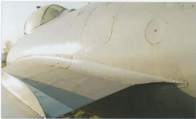
Fuselage-wing joint and fuselage port side access panels • Połączenie kadłub-skrzydło i wzniki eksploatacyjne na lewej stronie kadłuba
