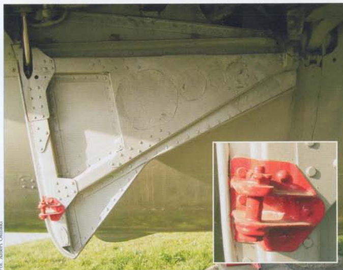
Port wing main landing gear well (fuselage side); note hydraulic actuator of the bay door • Przykadłubowa część wnętrza podwozia głównego w lewym skrzydle z silownikiem hydraulicznym zamykania pokrywy
