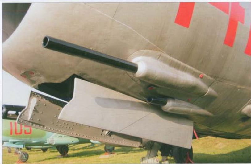
Port side of the fuselage with two NR-23 cannons (80 rounds per each gun) • Lewa strona kadłuba z dwoma działkami NR-23 zaopatrzonymi w 80 sztuk amunicji każde
