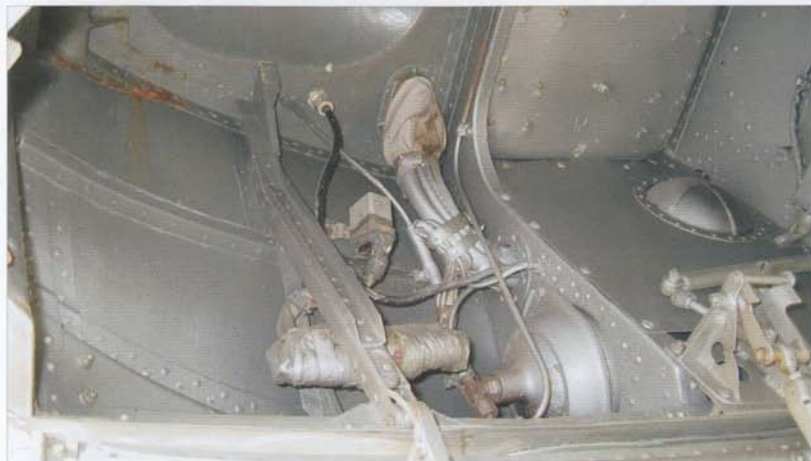
Front landing gear well. Its upper part features a bulge to house the wheel in its retracted position • Komora podwozia przedniego. Jej górna część zawiera przetłoczenie na chowane koło podwozia
