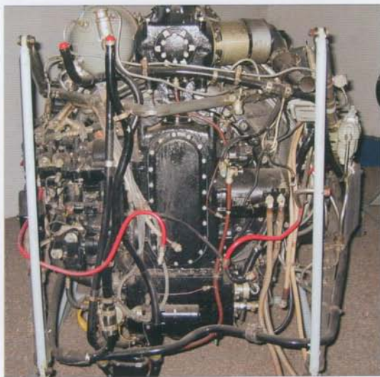
Lis-5 engine details. The engine was set in motion by ST-2-48W electrical starter and fed by kerosene T-1 jet fuel • Detale silnika Lis-5. Silnik uruchamiany był rozrusznikiem elektrycznym ST-2-48W i zasilany był naftą T-1
