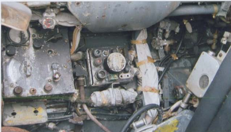
Starboard sidewall tuning panel of ARK-5 radio compass (central part of the right console) • Prawa strona kabiny pilota z pulpitem strojenia radiokompasu ARK-5 (środkowa część prawej konsoli)
