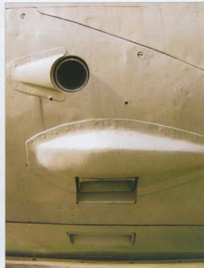
NR-23 cannons and their ammunition belt links and shell ejection ports • Działka NR-23 oraz ich wyrzutniki ogniwi i husek z lewej strony kadłuba
