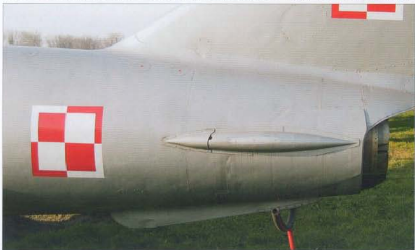
Empennage section. Note MiG-17F's enlarged air brake and afterburner nozzle • Tylne usterzenie. MiG-17F posiadał powiększony w porównaniu z wcześniejszą wersją hamulec aerodynamiczny i wystającą dyszę dopalacza
