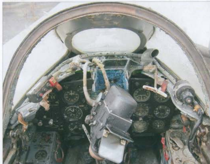
Central section of the instrument panel with ASP-4NM gunsight. The lever visible to the right is the canopy emergency release • Środkowa część kabiny z tablicą przyrządów pilota i celownikiem ASP-4NM. Dźwignia po prawej stronie celownika służyła do awaryjnego zrzutu osłony kabiny
