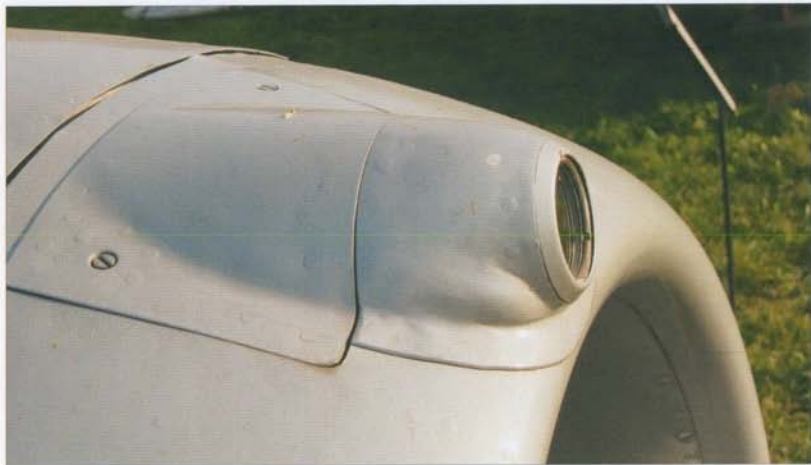
S-13 gun camera positioned in the upper part of the nose air intake. It was synchronized with the gun trigger • Fotokarabin S-13 umieszczony w górnej części wlotu powietrza do silnika. Uruchamiany był wraz z użyciem uzbrojenia
