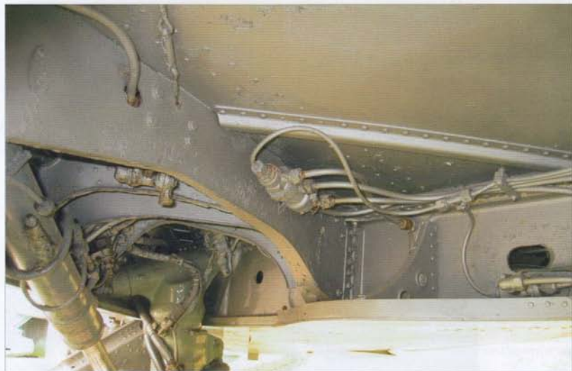
Starboard main landing gear well viewed from the fuselage side. Note the wheel leg joint • Prawa wnęka podwozia głównego widoczna od strony kadłuba. Węzeł mocowania goleni
