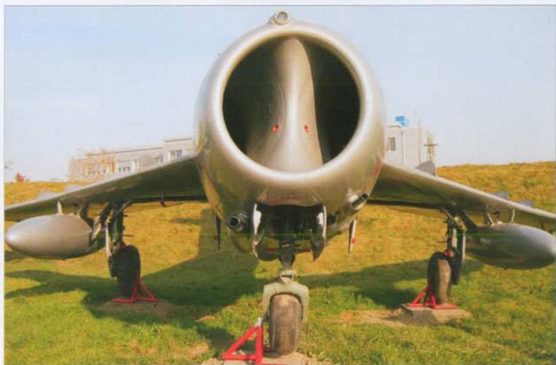
Front section of the fuselage featuring nose engine air intake, gun bay, front landing gear well and cockpit. The vertical, red-painted rod just ahead of the windshield is a mechanical indicator of undercarriage position • Część przednia kadłuba zawierająca wlot powietrza do silnika, lawetę z uzbrojeniem, wnękę podwozia przedniego oraz kabinę pilota. Przed osłoną kabiny pilota mechaniczny wskaźnik wysunięcia podwozia
