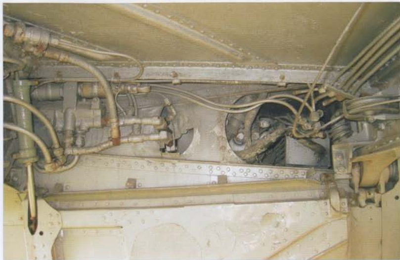
Port landing gear well and the leg actuator • Wnęka lewego podwozia z dźwignikiem wciągania podwozia
