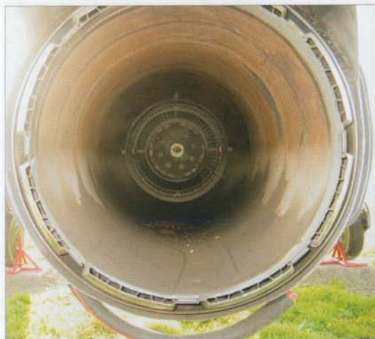
Adjustable nozzle and inner part of the engine • Dysza nastawna i wewnętrzna część silnika
