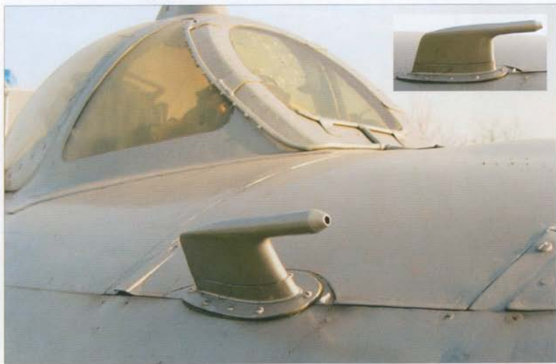
S-13 gun camera positioned in the upper part of the nose air intake. It was synchronized with the gun trigger • Fotokarabin S-13 umieszczony w górnej części wlotu powietrza do silnika. Uruchamiany był wraz z użyciem uzbrojenia
