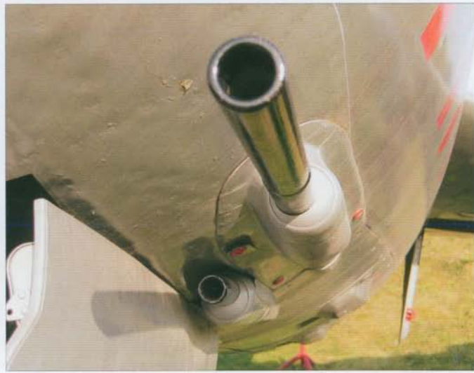
Port side of the fuselage with two NR-23 cannons (80 rounds per each gun) • Lewa strona kadłuba z dwoma działkami NR-23 zaopatrzonymi w 80 sztuk amunicji każde
