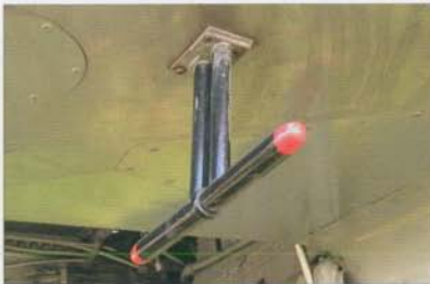
Radioaltimeter RW-2 • Antena radiowysokościomierza RW 2
