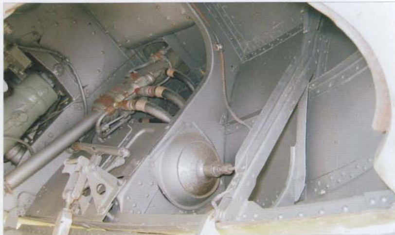
Left side of the well with visible actuators • Lewa strona komory z widoczną mechanizacją chowania drzwi komory
