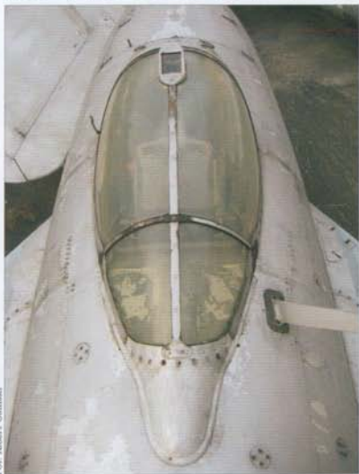
Cockpit comprised fixed front part and rearward-sliding hood. Note the blade antenna on the upper rear fuselage (starboard side, aft of the cockpit) • Osłona kabiny pilota. Część przednia była nieruchoma. Część tylna była odsuwana do tyłu. Po prawej tylnej stronie osłony kabiny znajdowała się antena mieczowa
