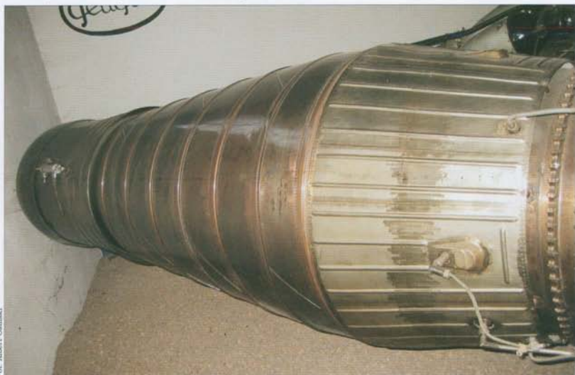
Lis-5 engine (licence-built WK-1F) used in MiG-17/Lim-5 • Silnik Lis-5 (licencyjny WK-1F) stosowany w samolotach Mig-17/Lim-5
