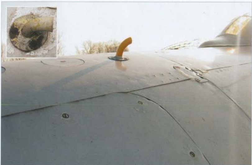
Fuselage-wing joint and fuselage port side access panels • Połączenie kadłub-skrzydło i wzniki eksploatacyjne na lewej stronie kadłuba
