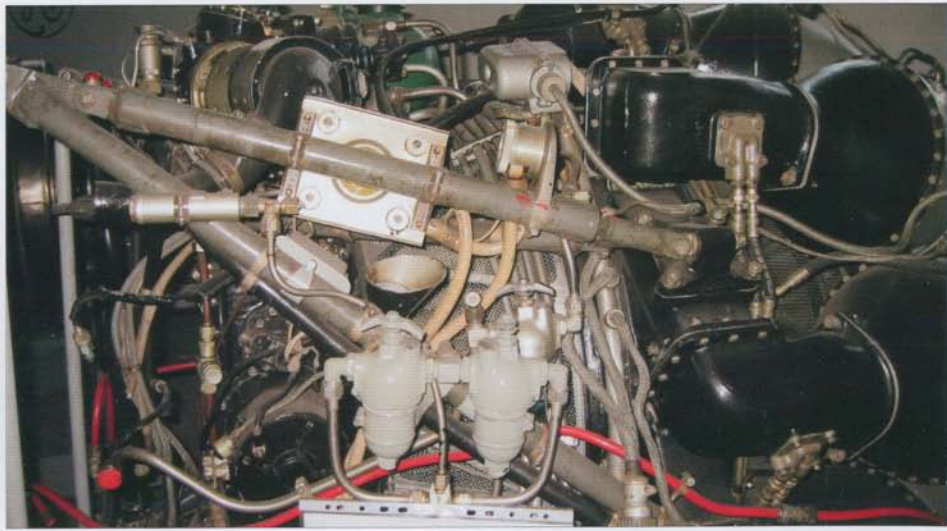
Lis-5 engine details. The engine was set in motion by ST-2-48W electrical starter and fed by kerosene T-1 jet fuel • Detale silnika Lis-5. Silnik uruchamiany był rozrusznikiem elektrycznym ST-2-48W i zasilany był naftą T-1
