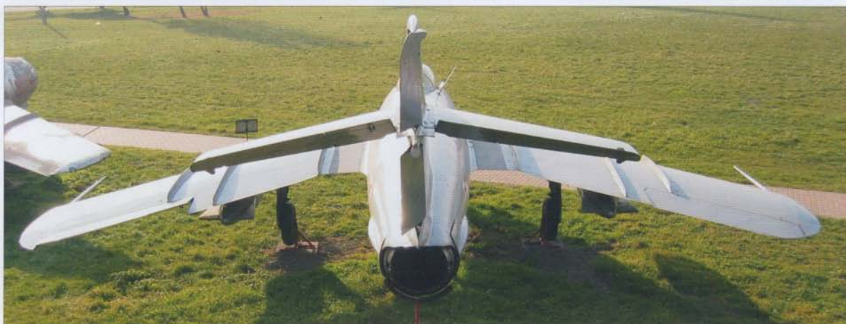
Lim-5 viewed from the rear. Note its swept wing with a "compound sweep" configuration: 45° angle near fuselage and 42° angle of outer parts • Lim-5 w widoku od ogona. Widoczny skośny układ skrzydeł o zmiennym skosie krawędzi natarcia. W części przykadłubowej 45°, dalej 42°
