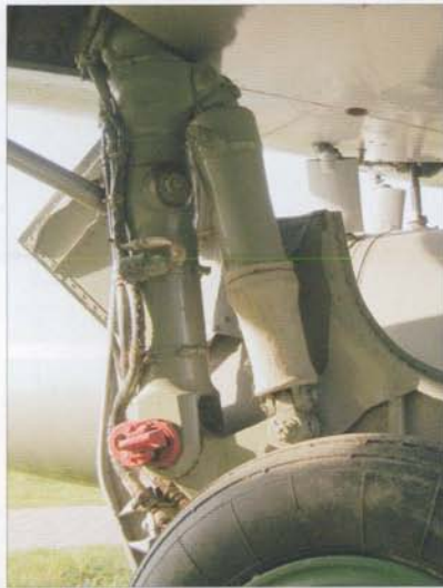
Details of the starboard main landing gear: shock-absorber, wheel, hydraulic installation and covers • Detale prawego podwozia głównego: amortyzator, koło, instalacja hydrauliczna i osłony
