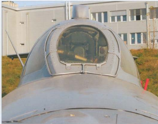
Cockpit comprised fixed front part and rearward-sliding hood. Note the blade antenna on the upper rear fuselage (starboard side, aft of the cockpit) • Osłona kabiny pilota. Część przednia była nieruchoma. Część tylna była odsuwana do tyłu. Po prawej tylnej stronie osłony kabiny znajdowała się antena mieczowa
