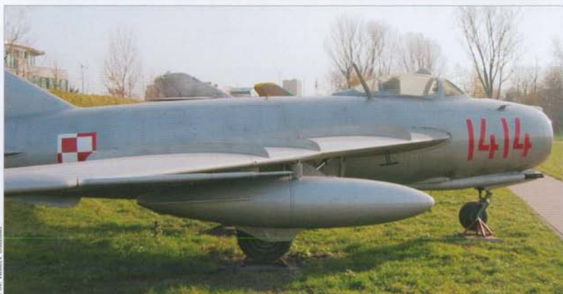
Front section of the fuselage featuring nose engine air intake, gun bay, front landing gear well and cockpit. The vertical, red-painted rod just ahead of the windshield is a mechanical indicator of undercarriage position • Część przednia kadłuba zawierająca wlot powietrza do silnika, lawetę z uzbrojeniem, wnękę podwozia przedniego oraz kabinę pilota. Przed osłoną kabiny pilota mechaniczny wskaźnik wysunięcia podwozia
