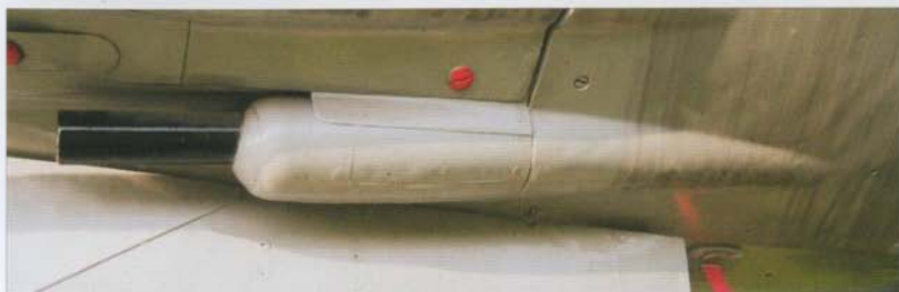
NR-23 cannons and their ammunition belt links and shell ejection ports • Działka NR-23 oraz ich wyrzutniki ogniwi i husek z lewej strony kadłuba
