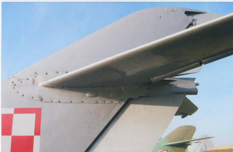
Port tailplane (vertical stabilizer) and elevator • Lewy statecznik poziomy ze sterem wysokości
