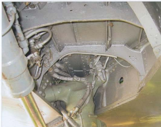
Starboard main landing gear well viewed from the fuselage side. Note the wheel leg joint • Prawa wnęka podwozia głównego widoczna od strony kadłuba. Węzeł mocowania goleni
