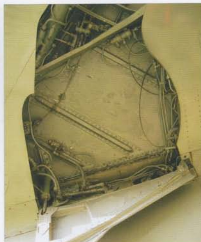
Port landing gear well and the leg actuator • Wnęka lewego podwozia z dźwignikiem wciągania podwozia
