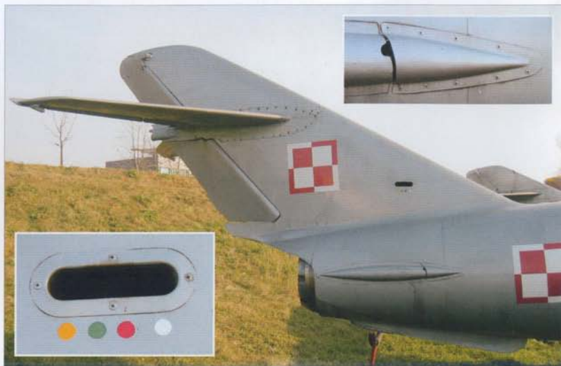
Tail assembly and engine. Starboard side of the tailfin is equipped with a flare launcher. Note the ventral fin with a ground bumper • Tylna część kadłuba z silnikiem oraz usterzeniem poziomym i pionowym. Po prawej stronie statecznika pionowego znajduje się rakietnica sygnałowa. Pod kadłubem grzebień zabezpieczający przed uszkodzeniami
