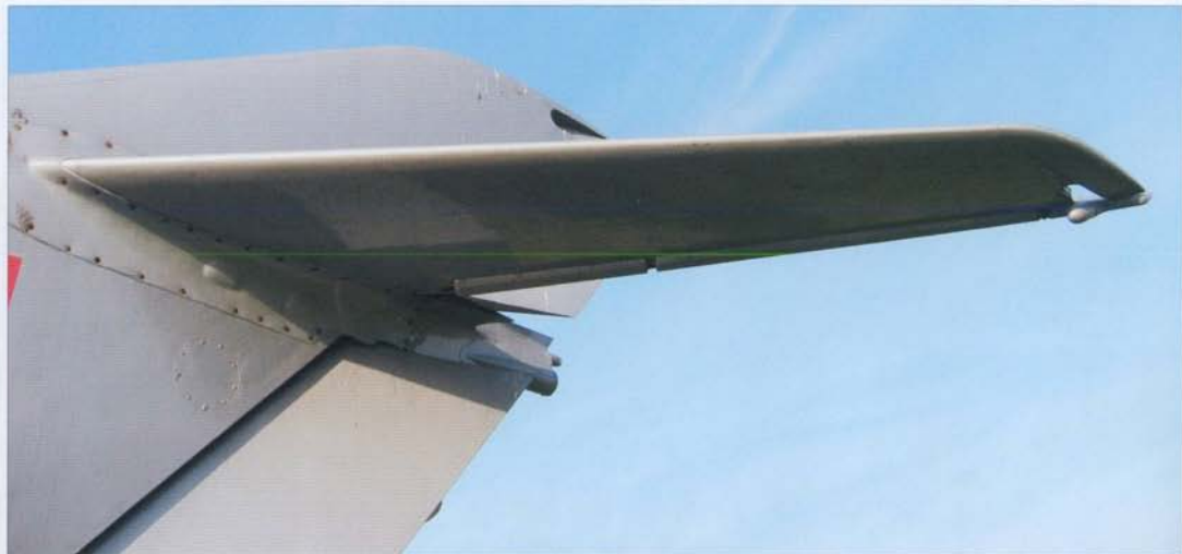
Port tailplane (vertical stabilizer) and elevator • Lewy statecznik poziomy ze sterem wysokości
