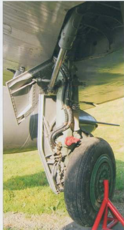
Starboard main landing gear leg • Prawa goleń podwozia głównego
