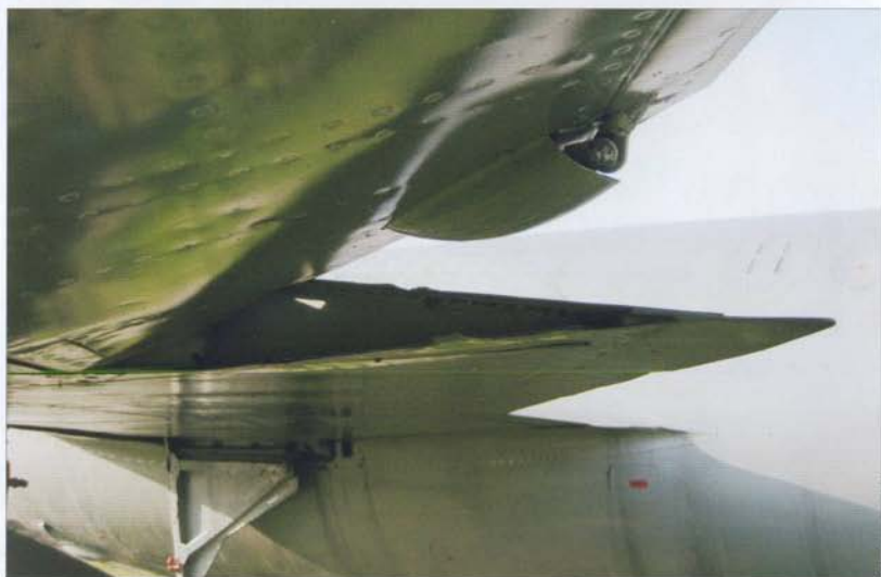
Port wing's lowered aileron • Wychylona lotka lewego skrzydła
