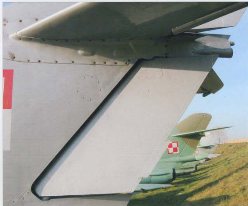
Upper and lower part of rudder • Górna i dolna część steru kierunku
