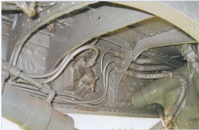
Starboard main landing gear well viewed from the fuselage side. Note the wheel leg joint • Prawa wnęka podwozia głównego widoczna od strony kadłuba. Węzeł mocowania goleni
