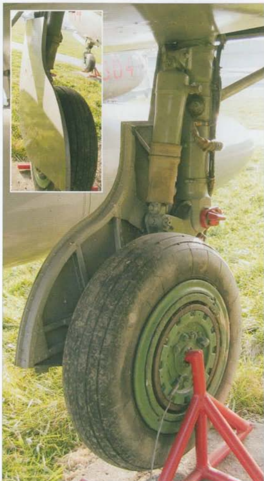
Port main landing gear leg; visible are brake lines and the light signalling the position of the undercarriage • Lewa goleń podwozia głównego z instalacją hamulcową oraz światłem wypuszczenia podwozia
