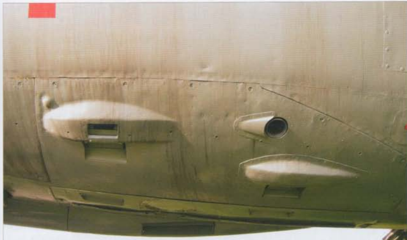
NR-23 cannons and their ammunition belt links and shell ejection ports • Działka NR-23 oraz ich wyrzutniki ogniwi i husek z lewej strony kadłuba
