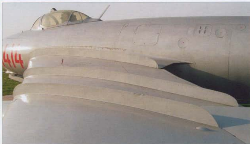
Port wing with air flow fences. Located between them is a mechanical undercarriage position indicator • Lewy płatek z widocznymi dobrze grzebieniami aerodynamicznymi. Pomiędzy nimi znajduje się mechaniczny wskaźnik wysunięcia podwozia
