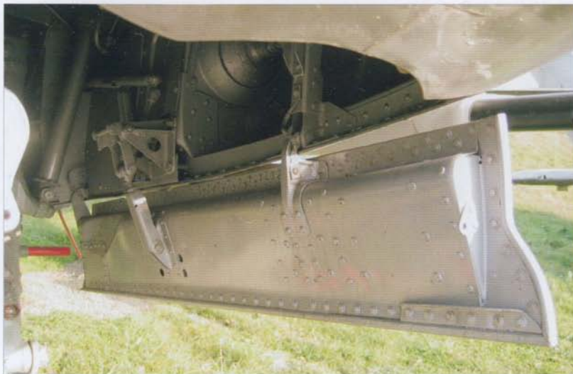
Left side of the well with visible actuators • Lewa strona komory z widoczną mechanizacją chowania drzwi komory
