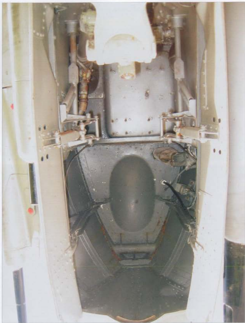
Front landing gear well. Its upper part features a bulge to house the wheel in its retracted position • Komora podwozia przedniego. Jej górna część zawiera przetłoczenie na chowane koło podwozia
