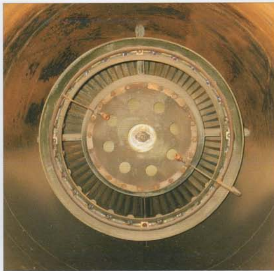
Adjustable nozzle and inner part of the engine • Dysza nastawna i wewnętrzna część silnika
